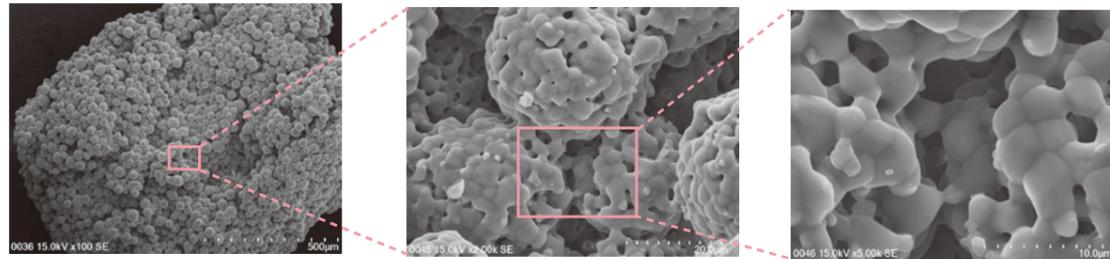
球状粒子間のマクロサイズの間隙
