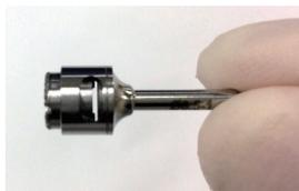
③ドリルの先端を軽く触り空回り、磁力の反発を確認してください。
