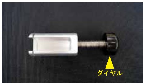
③イリゲーションのダイヤルを反時計回りに廻し写真の位置まで緩めます。
